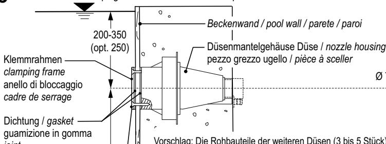
Vorschlag: Die Rohbauteile der weiteren Düsen (3 bis 5 Stück) schließen sich in einem seitlichen Abstand von - 1,5 m waagrecht oder wahlweise in gerader Linie fallend bis auf einen Abstand von 600 mm vom Beckenboden zum Rohbauteil der letzten Düse an.
