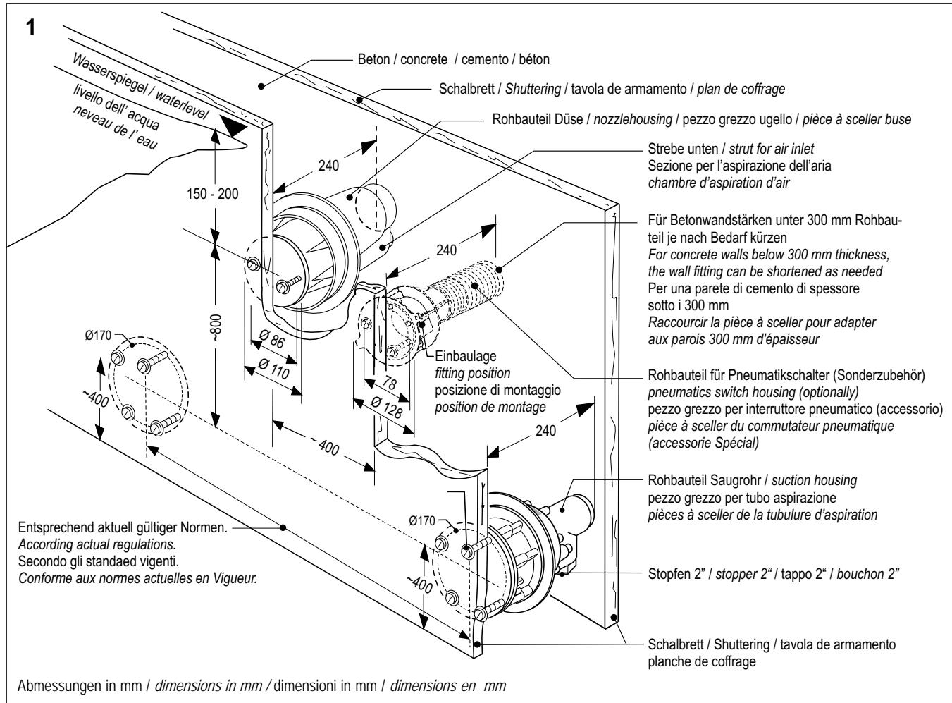
Haben Sie ein Düsen-Rohbauteil eingebaut, schliessen sich alle weiteren (3 bis 5 Stück) in einem waagrechten Abstand von ca. 1,5 m oder in gerader Linie fallend bis zu einem Bodenabstand von 60 cm an.
