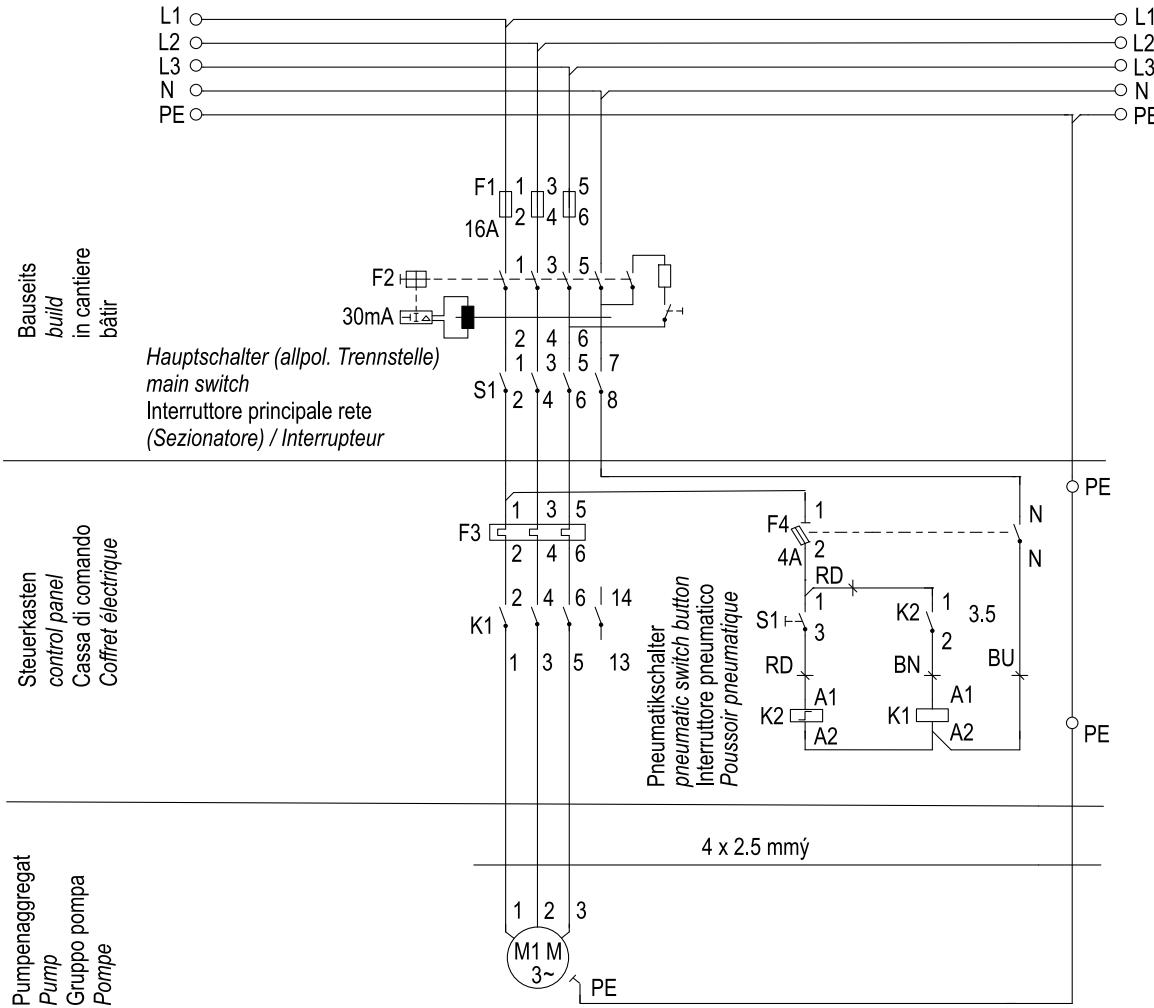
Sicherung FI Schalter 30 mA, Hauptschalter sind bauseits nach den gültigen DIN VDE Bestimmungen anzubringen
