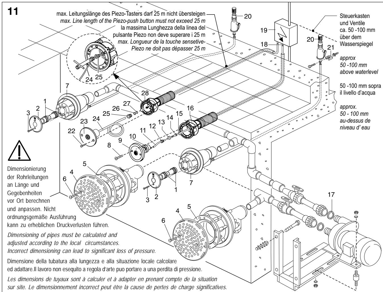
massage oder bei mutwilligem Verschliessen der Düse entstehen kann. Das Ventil verhindert, daß Wasser aus dem Luftansaug-schlauch spritzt. Das Ventil ist nur solange dicht, solange sich keine Ablagerungen oder Haare darin festsetzen. Deshalb das Ventil unbedingt über dem Wasserspiegel anbringen.
